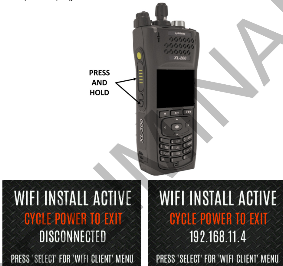
Figura A-5: Habilite el modo de programación Wi-Fi en la radio
