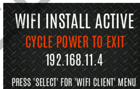
Figura 6-2: Instalación de Wi-Fi activa
