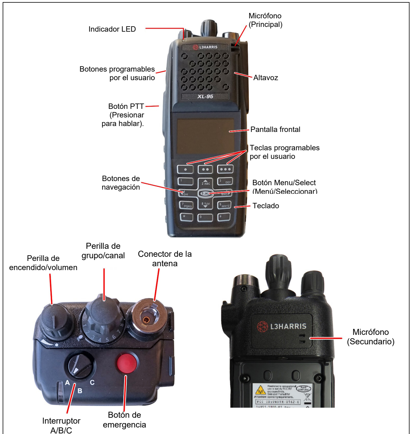
Figura 4-1: Controles de radio, indicadores y conectores
