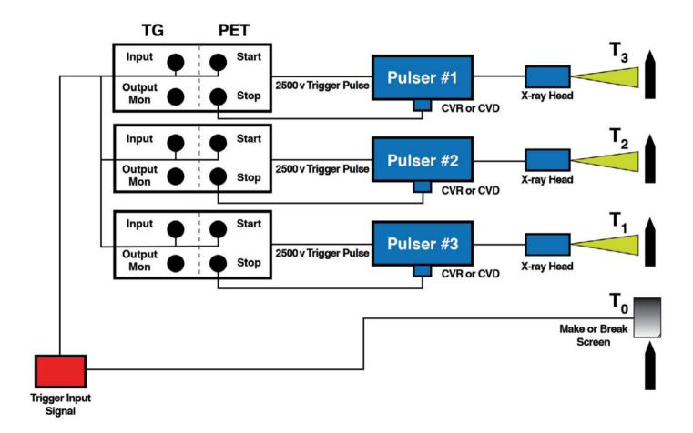
**EXAMPLE: TYPICAL 3 PULSER RANGE INSTRUMENTATION WITH XCON**
